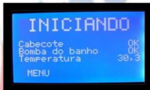
Ao ser atingida a temperatura no banho de  $-5^{\circ}\text{C}$  aparecerá a tela abaixo, indicando que o crioscópio está pronto para fazer as análises.
