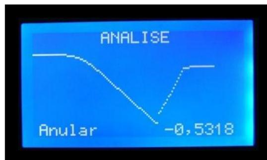
Assim que os valores atingirem o plateau, o crioscópio irá travar as medidas, subirá o cabeçote e serão indicados no display os valores da crioscopia do leite e da água adicionada.
