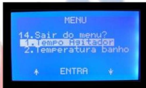
Através do botão correspondente a seta, escolha o tempo desejado. Para testar o funcionamento pressione a tecla “**LIGA**”, onde o agitador irá vibrar durante o tempo determinado, simulando a “batida” de uma análise.
