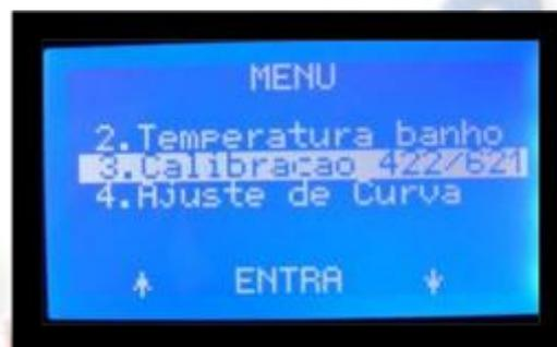
Aparecerá a tela abaixo, onde estará piscando o valor **422**. Coloque de **2** ml a **2,5** ml de solução **442** em um tubo de ensaio e faça a **ANÁLISE**.
