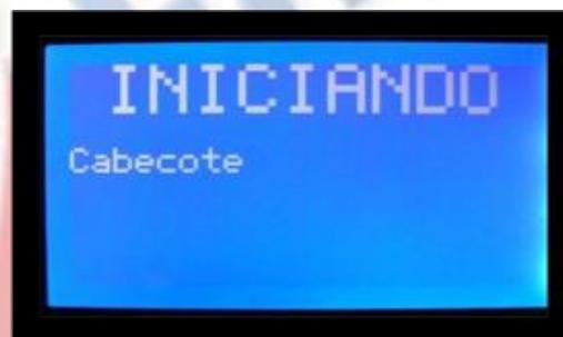
Após a subida do cabeçote, aparecerá um indicação de **OK** na frente e iniciará o funcionamento da bomba peristáltica, responsável pelo enchimento automático do banho refrigerado com solução anti-congelante
