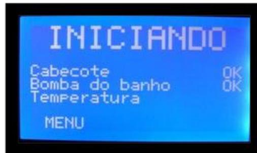
A temperatura banho mostrada deverá ser inicialmente próxima da temperatura ambiente, caindo progressivamente até a temperatura pré-ajustada, normalmente de  $-7^{\circ}\text{C}$ .
