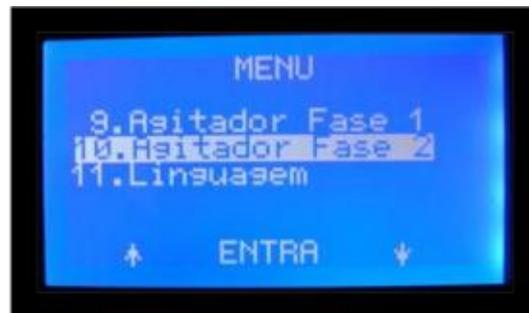
O agitador estará desligado. Na parte inferior do display há as opções, **Liga** e **Desliga**. Pressionando a opção Liga, o agitador funcionará em toda sua amplitude.
