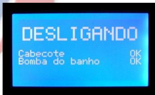
Após a conclusão do esvaziamento automático do banho, o equipamento será totalmente desligado.
